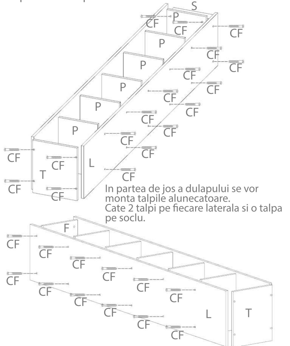
Dupa montare, se intoarce dulapul cu cantul spre podea, si se va prinde HDF-ul cu ajutorul cuiutelor.(C)
