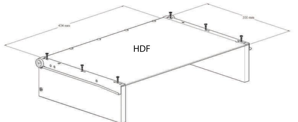
Se monteaza glisierele si in interiorul dulapului.
