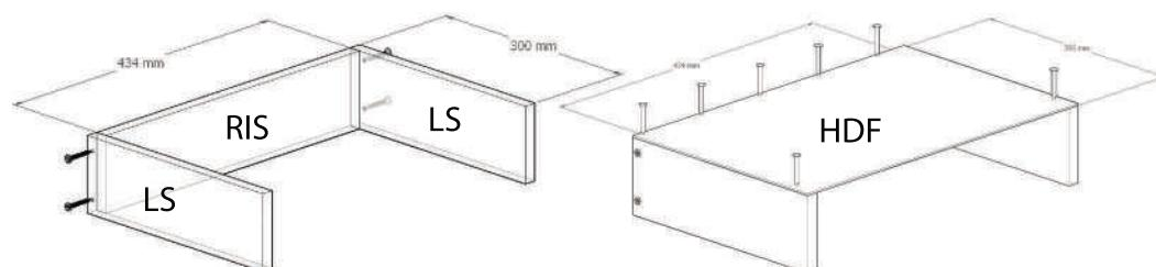
Lateralele sertarelor se vor prinde cu surub 3,5x40(S5), apoi se va intoarce sertarul cu cantul spre podea si se va prinde HDF-ul.
