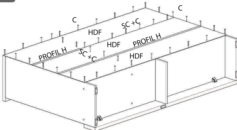
Inainte de a prinde HDF-ul se va verifica cu o ruleta sau un echer daca corpul este in vinclu, adica la 90 de grade.
