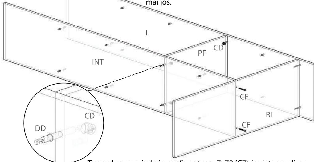
Tavanul se va prinde in confirmatoare 7x70 (C7), iar intermediara se va prinde in confirmatoare 7x50(CF)
