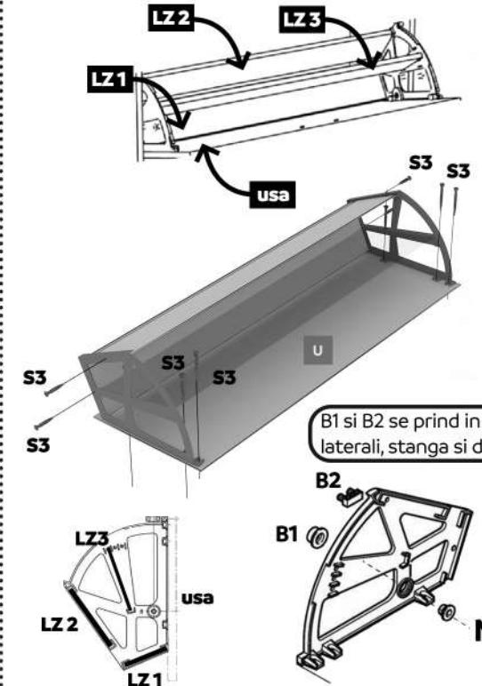
Se monteaza sistemul de pantofar XP cu cate 3 suruburi **S3** in usa, si prin suruburi **S3** in laterale.
